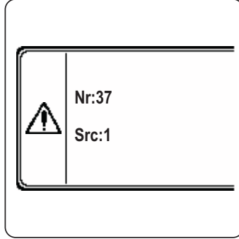
şek. 30 - Modül 1 yetersiz sistem basıncı arızası
