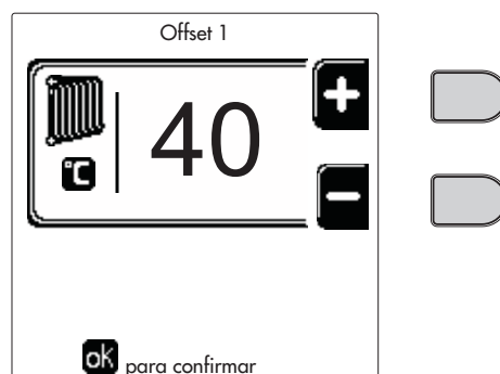
fig. 27 - Desplazamiento paralelo de las curvas
